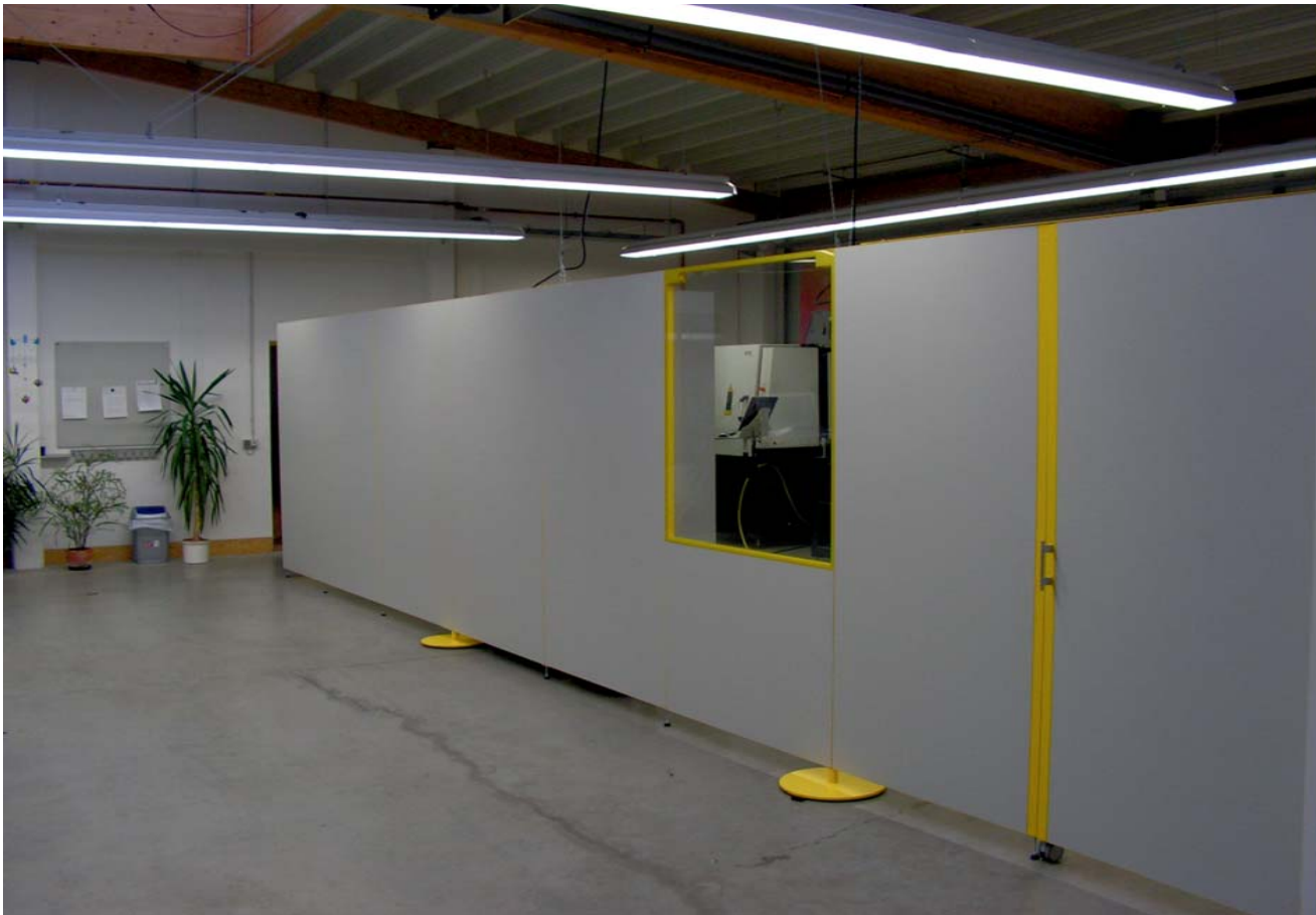
Stellwand als Abtrennung in der Fertigung
